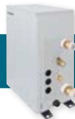
Modulo idronico per produzione acqua calda per applicazioni con temperatura massima in mandata 50°C (Tmax ritorno 45°C). Utili per riscaldamento attraverso terminali idronici o radianti al pavimento.
